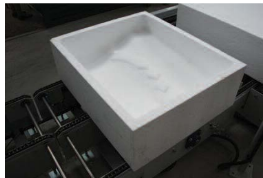
Støbeform i polystyren bearbejdet af robotten
