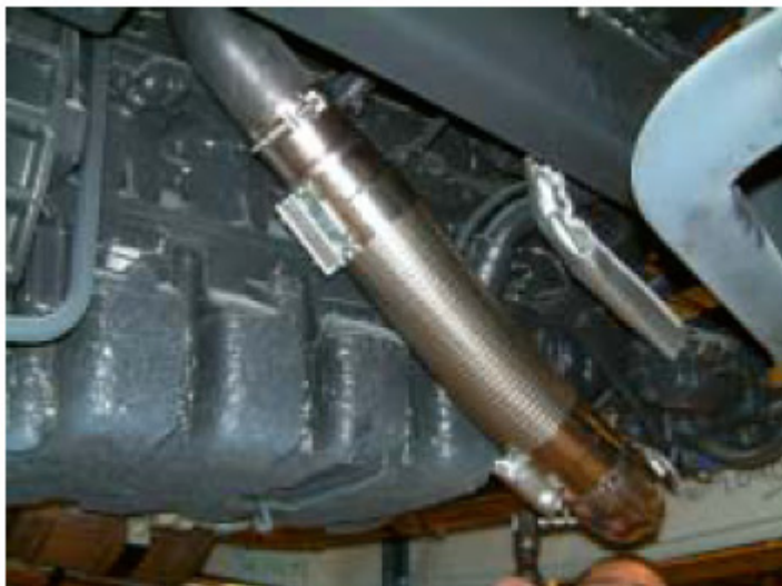
Fig. 6 – Typisk flexibel slange på udstødning
