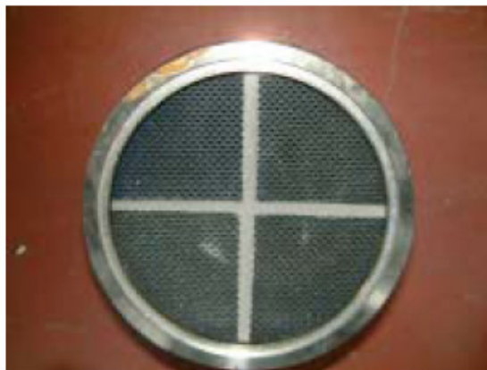
Fig 9. Udløbssiden af et brugt filter
