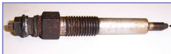
Figur 6 viser et nedslidt gløderør
