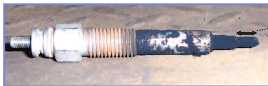
Figur 5 viser en normalt slidt spids
