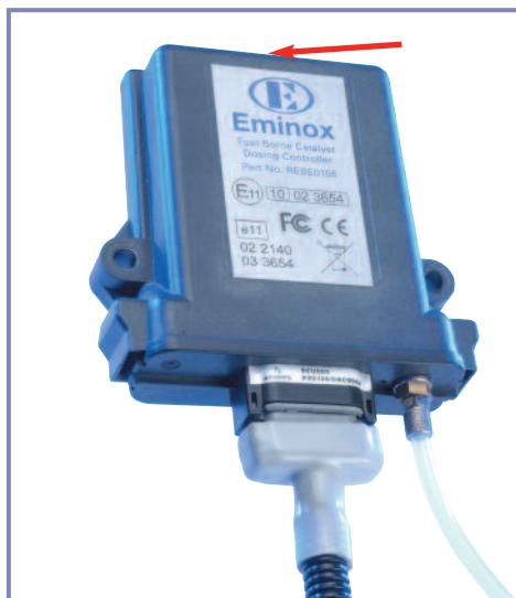
Figur 13 – Placering af reedafbryder
