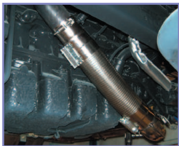
Figur 18 - Typisk flexrør, som beskytter mod vibrationer
