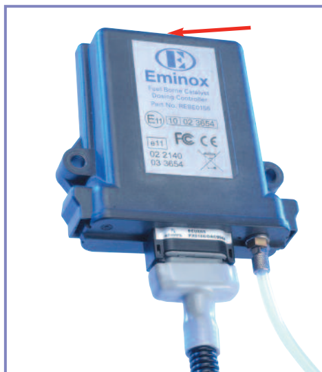
Figur 13 – Placering af reedafbryder
