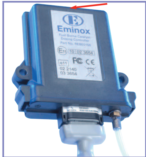
Figur 10 - placering af reedafbryder
