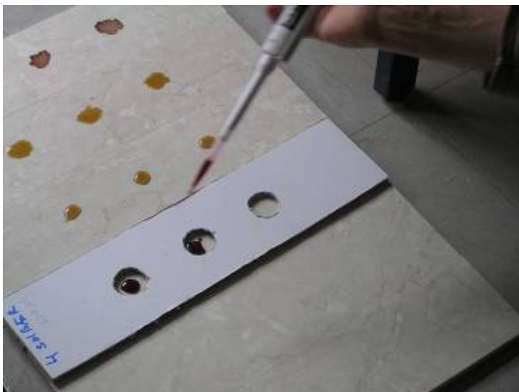
Foto 17. Skabelon med 35 mm hul, der sikrer ens størrelse og afstandsmønster under påføring af pletter.
