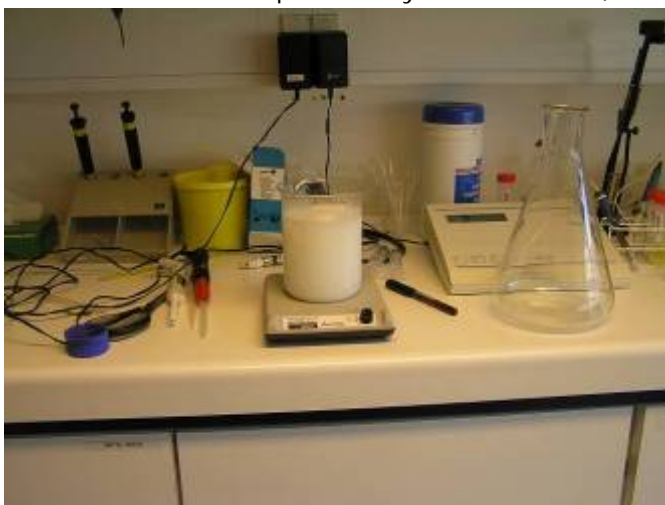
Foto 13. 0,50 % sæbevandsopløsning klargøres i omrører.
