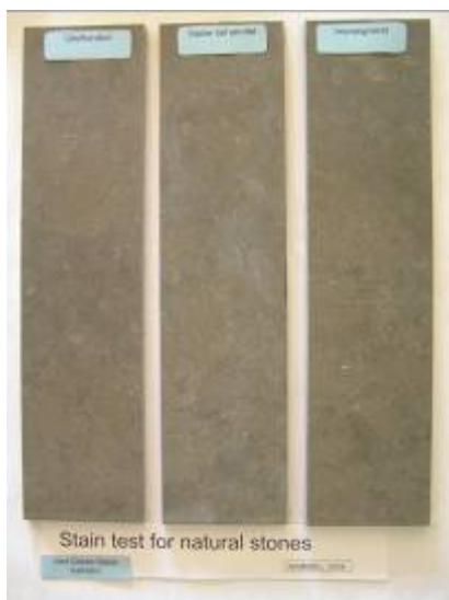
Foto 24. Situation 1. 3 stenemne nr. 1, 7, og 13 efter overfladebehandling.
