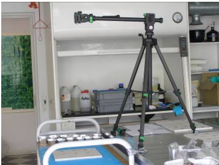
Foto 29. Fotoopstilling optagelser af stenemner i forbindelse med plettesten
