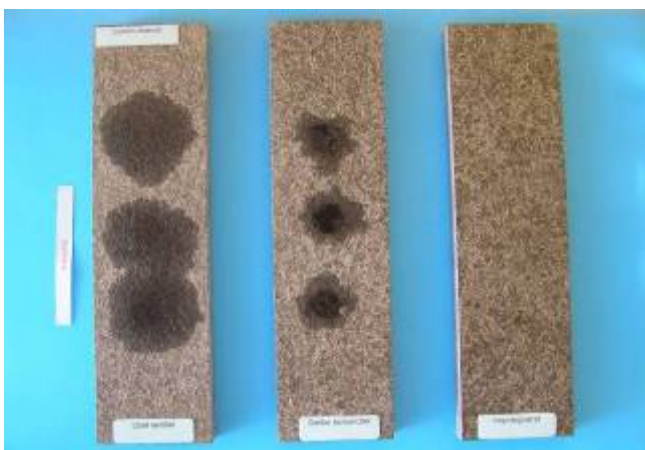
Foto 19. En Gabbro, der er plettet med 0,15 ml madolie 2 time efter påføringen. Stenemnet længst til venstre er overfladen ubehandlet. Olie har bred sig betydeligt. Mod højre, ses oliepletter på sæbebehandlet overflade, hvor olien har bred sig mindre. Længst til højre ses stenemne med imprægneret overflade ("WS"). Grundet imprægneringen med "WS", udebliver oliens flydende egenskab i horisontal og vertikal retning.
