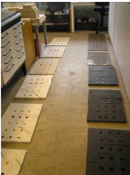
Foto 23. Eksempel på opstilling af stenemner som det tager sig ud ved pletvurderingen.
