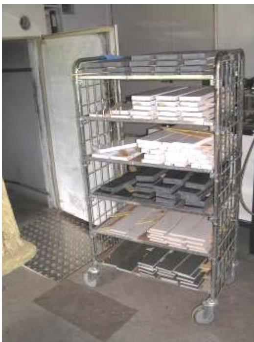
Foto 15. Stenemner på vej ind i ovnen, som ses til venstre i billedet.
