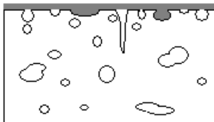
Figur 3.2: Principskitse af overfladebehandling med en belægningsfilm/polish (ikke indtrængende).
