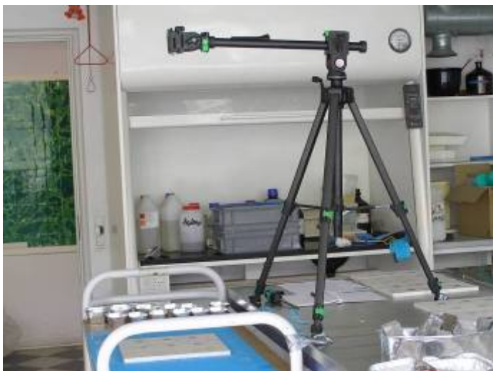
Foto 12. Fotostand for fotodokumentation af stenemnerne under plettesten.
