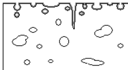
Figur 3.4: Principskitse af overfladebehandling med en imprægnering (indtrængende).
