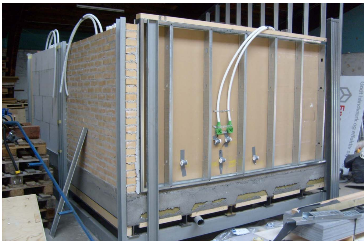
Figur 25. Placeringen af sensorer mellem stålreglerne i de lette vægge.
