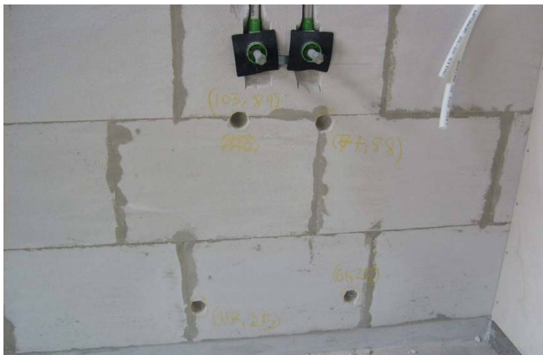
Figur 26. Placeringen af sensorer i den murede væg af letbeton.
