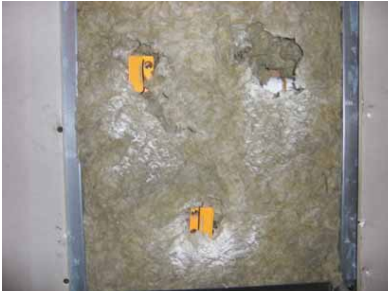
Figur 5: Sensors placering i stålregelvägg
