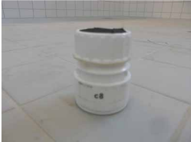
Figur 1: Behållare innehållande fuktsensor, batteri och antenn
