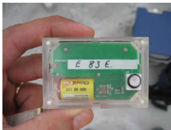
Figur 23. Foto af sensor uden ekstra indpakning. Hul til registrering af fugt er nederst til højre på sensoren.
