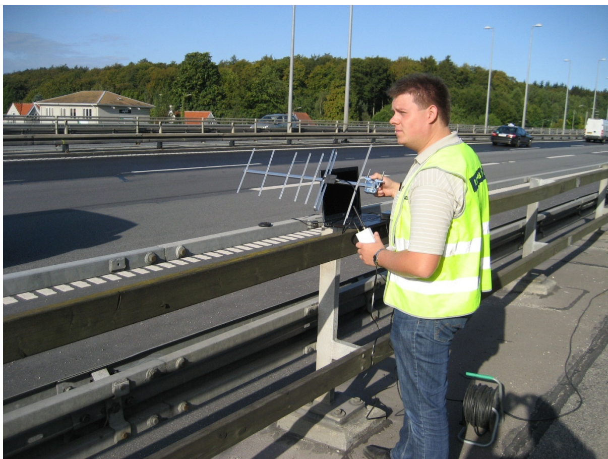
Figur 24. Måling på fugtsensorer på bro ved Skovdiget, Hillerødmetovvejen, ved Bagsværd.
