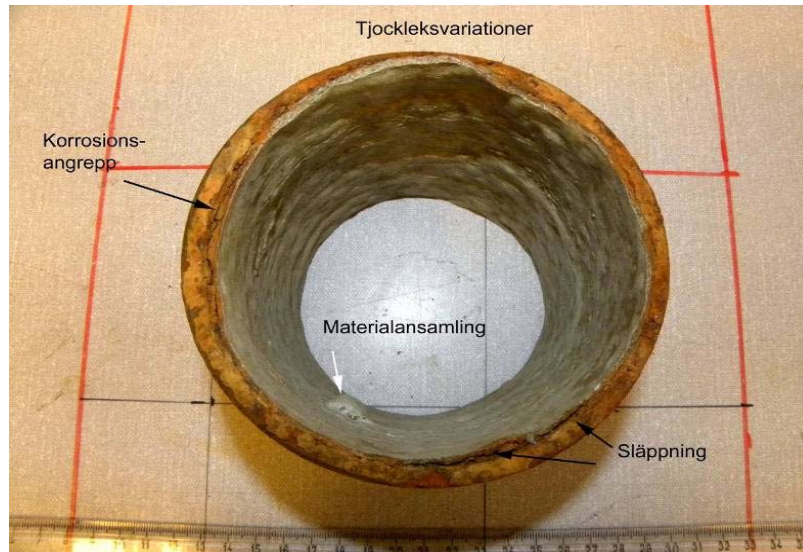
Figur 6 Översiktsbild över rörets tvärsnitt. Gjutjärnsröret uppvisar kraftigt korrosionsangrepp
