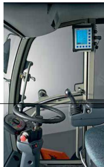
Fig 9. Proventia CHIB-installation på en arbejdsmaskine. Prøv at finde et sted til CHIB-enheden oven over den sorte streg.
