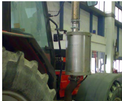
Fig 8. Proventia CHILI™ L installationsmuligheder på arbejdsmaskiner.
