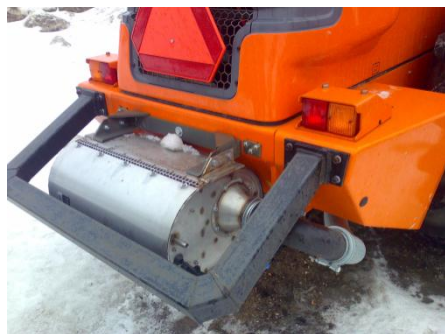
Fig 8. Proventia CHILI™ L installationsmuligheder på arbejdsmaskiner.
