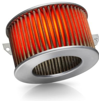
Fig 4. CHILI™ L filterelement under regenereringsfasen. Tilført elektrisk energi betyder, at CHILI™-filtret kan bruges til alle udstødningsgastemperaturer. CHILI™ kræver ikke NO 2 til regenerering, så CHILI™ er som et NO 2 -neutralt system.
