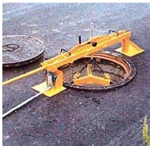
Figur 4.12 Eksempel på løfteværktøj til at hæve karme
