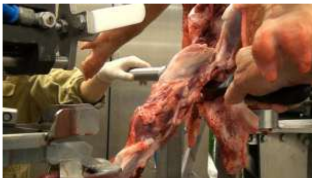
Billede 10: Tungen trækkes ud samtidig med at der holdes en kniv mod kæben som modhold.
