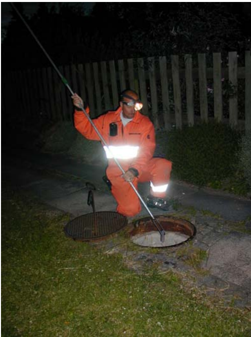
Figur 6.5 Udtagning af prøver, der analyseres for sporstof (Krüger A/S)
