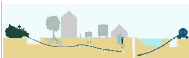
Figur 13.5 Opgravningsfri ledningsetablering ved styret boring
