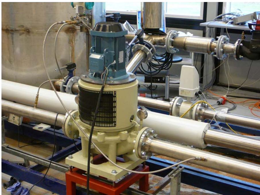
Figur 5.1. Test af NSL 80-265 med 4 kW asynkronmotor
