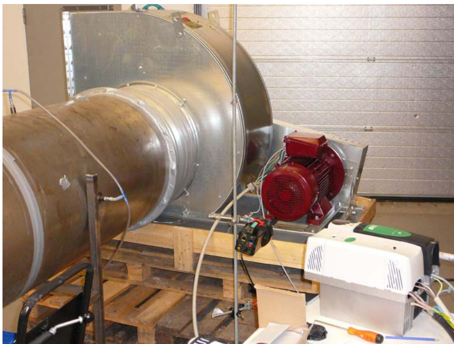
Figur 4.11. Test af GTHB-3-063 ventilator med PM motor
