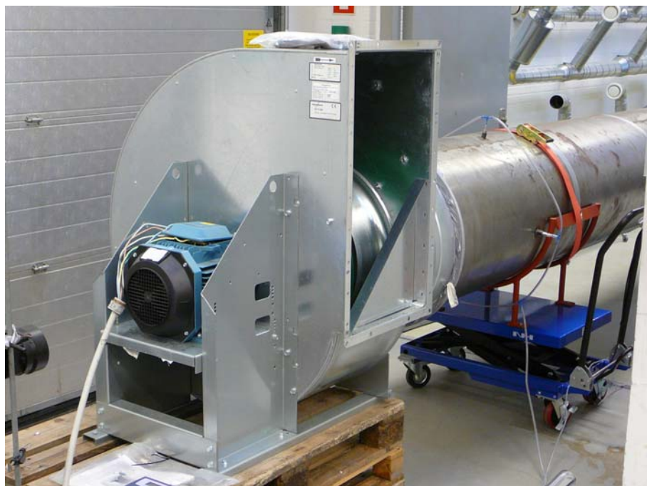
Figur 4.1. Test af GTLB-1-063 ventilator med asynkronmotor.
