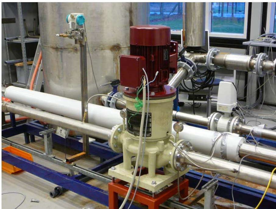
Figur 5.10. Test af NSL 80-215 med PM motor
