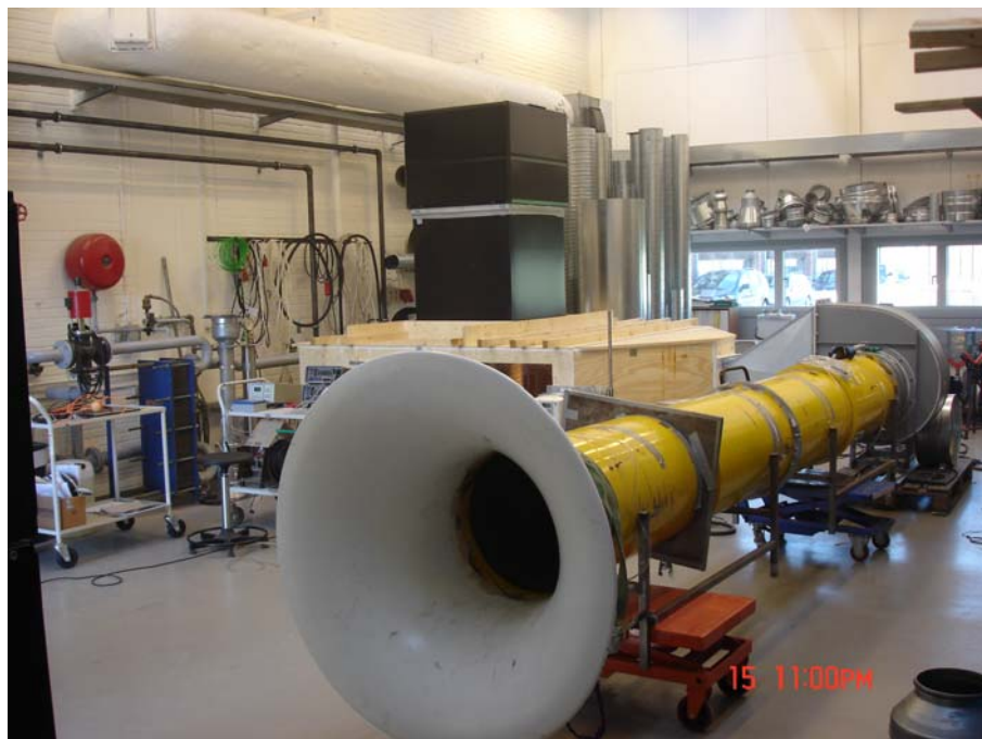
Figur 4.9. Opstilling til ventilationstekniske målinger på STEF tagventilatorer.
