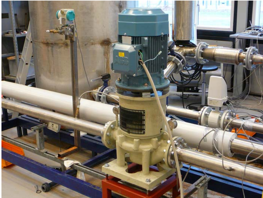
Figur 5.7. Test af NSL 80-215 med asynkronmotor
