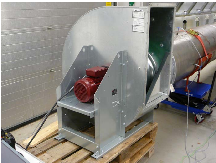
Figur 4.4. Test af GTLB-1-063 ventilator med PM motor
