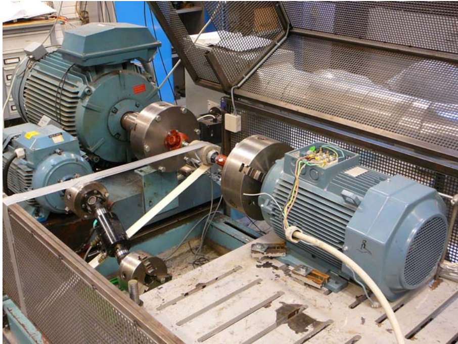
Figur 3.12. Måleopstilling (18,5 kW asynkronmotor, momentmåler og generator).
