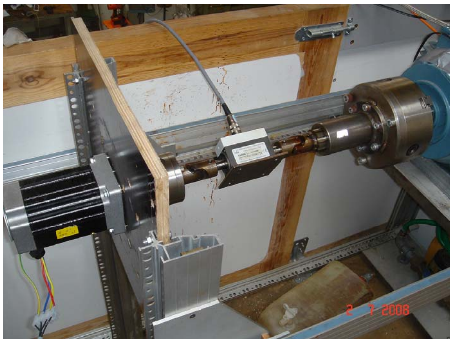
Figur 3.17. Måleopstilling (EC motor, momentmåler og generator).
