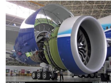
Axial compressors: FAN: 1700 m 3 /s, Pr=1,5 Core: 188 M 3 /s, Pr=42 Eta pol = 0,90
