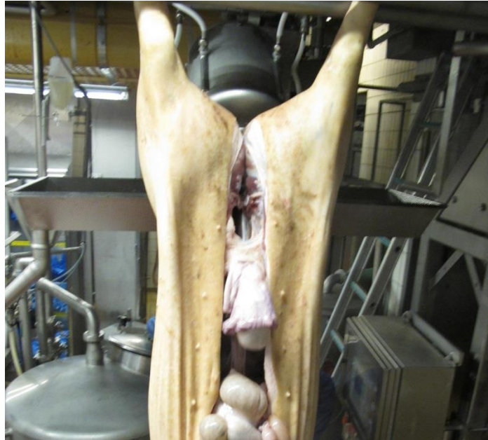
Figur 1: Udstyret set fra bug siden. Fedtenden er skubbet igennem bækkengangen og lagt i en pose bestående af krøshinder; rør med kop er ikke returneret.
