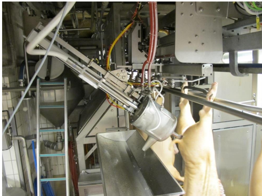
Figur 2: Udstyret set fra ryg siden af slagtekroppen. Røret med kop er halvejs igennem bækkengangen.
