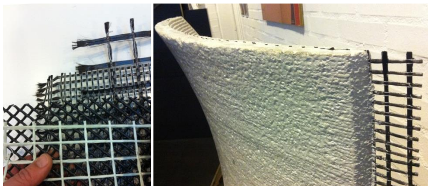
Figur 2.4-5 Eksperimental tekstilarmering fra EU-projektet Tailorcrete. Tv.: Udvalg af tekstilarmering, måtter i glas-, plast- og kulfibre. Th.: Krum, slank betonskal armeret med kulfiber-tekstil.
