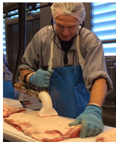
Billede 2: Sugehåndtag er udviklet frem til prototype, støjniveau 86 dB (Skal om muligt reduceres til 80 dB i forbindelse med det videre arbejde)
