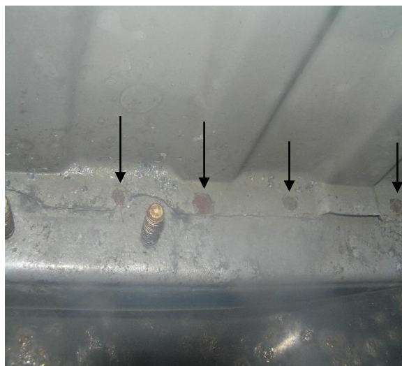
Behandling af tværvanger vanger og traverser samt hulrum i bundsektionen.
