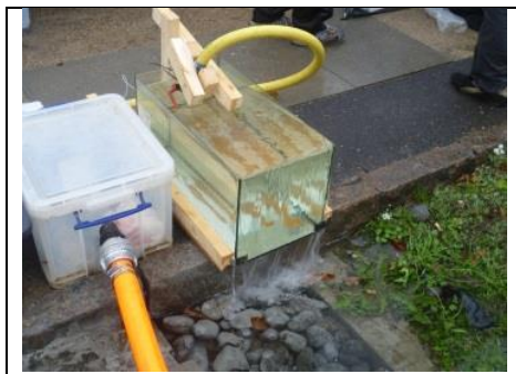
Figur 1: Foto fra forsøg med tilsætning af syntetisk vejvand til vejbed i Brønshøj. I akvariet fortyndes koncentrerede opløsninger (flaskerne med disse og doseringspumpen er uden for billedet) med vandværksvand fra brandhanevand (gul slange), hvorefter vandet løber over kanten af akvariet til indløbet i filterbedet. Flowhastigheden reguleres ved hjælp af ventil og flowmåler placeret i den hvide plastboks.
