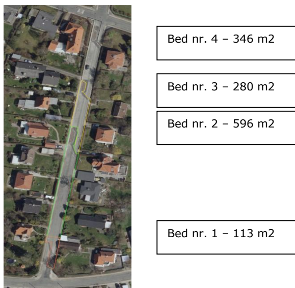
Figur 3: Markering af oplande hørende til de fire vejbede på Møllebakken. Oplandene er baseret på højdekurver. Fortov og vejbed er inkluderet i arealet.
