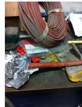
Til kabelføring, er modstandsdygtig overfor smeltet aluminium.
