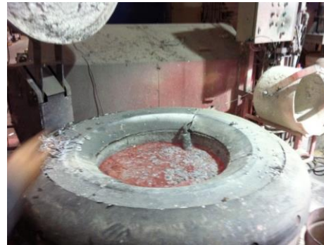
Smeltedigel med smeltet aluminium. Røret ned i metallet indeholder en Pt100-føler.
