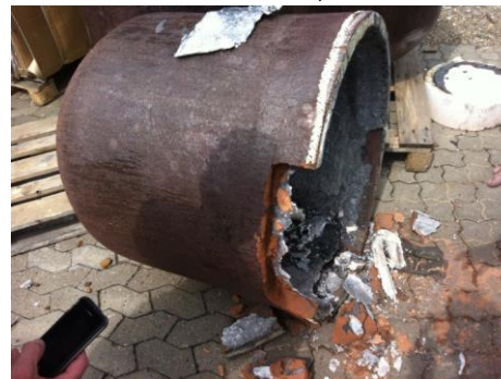
Ødelagt smeltedigel, materialet er grafitholdigt.
