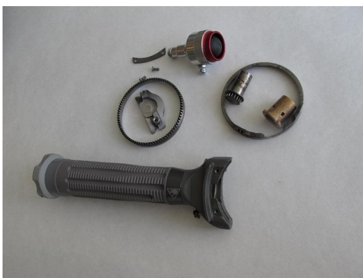
Figur 3: Whizardkniv adskilt i de dele, der er nødvendigt, hvis den skal gøres effektivt rent.
