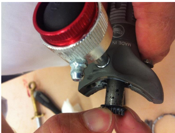
Figur 2: Stempelfarve på aksel bag tandhjul efter rengøring uden adskillelse.
