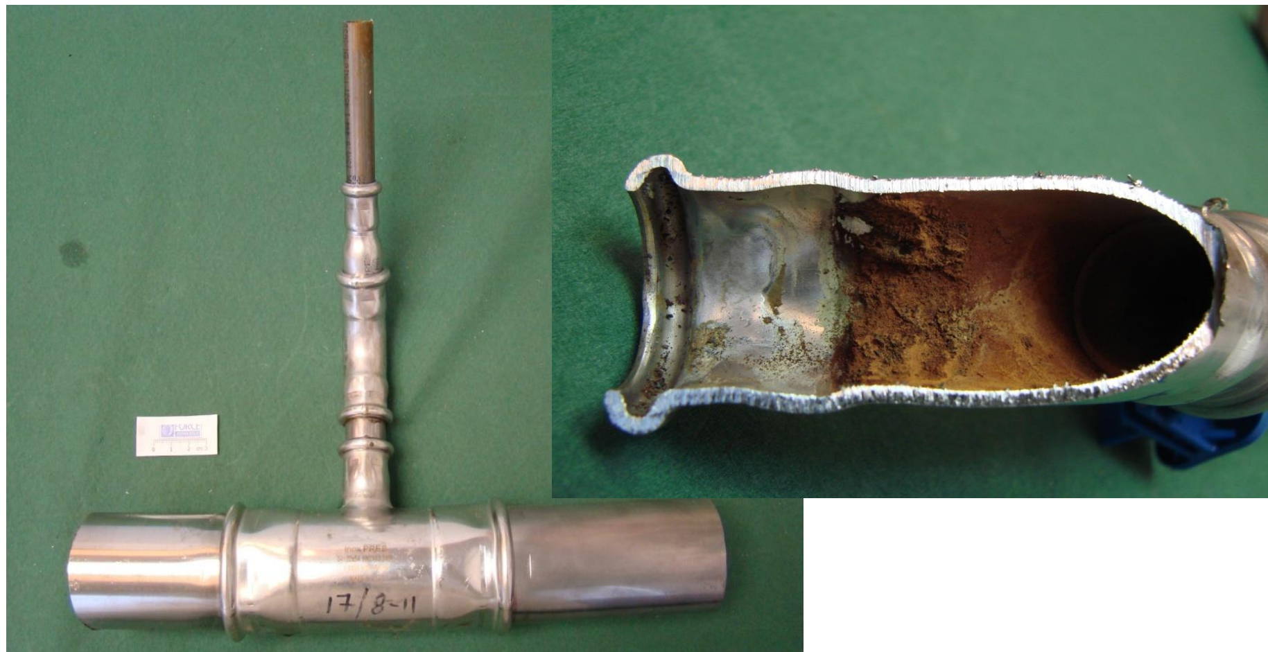
Korrosion på rør efter 6 måneders drift
