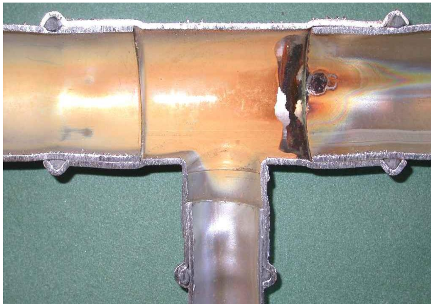
Spaltekorrosion, rør samlet med presfitting, EN 1.4404, Brugsvand
