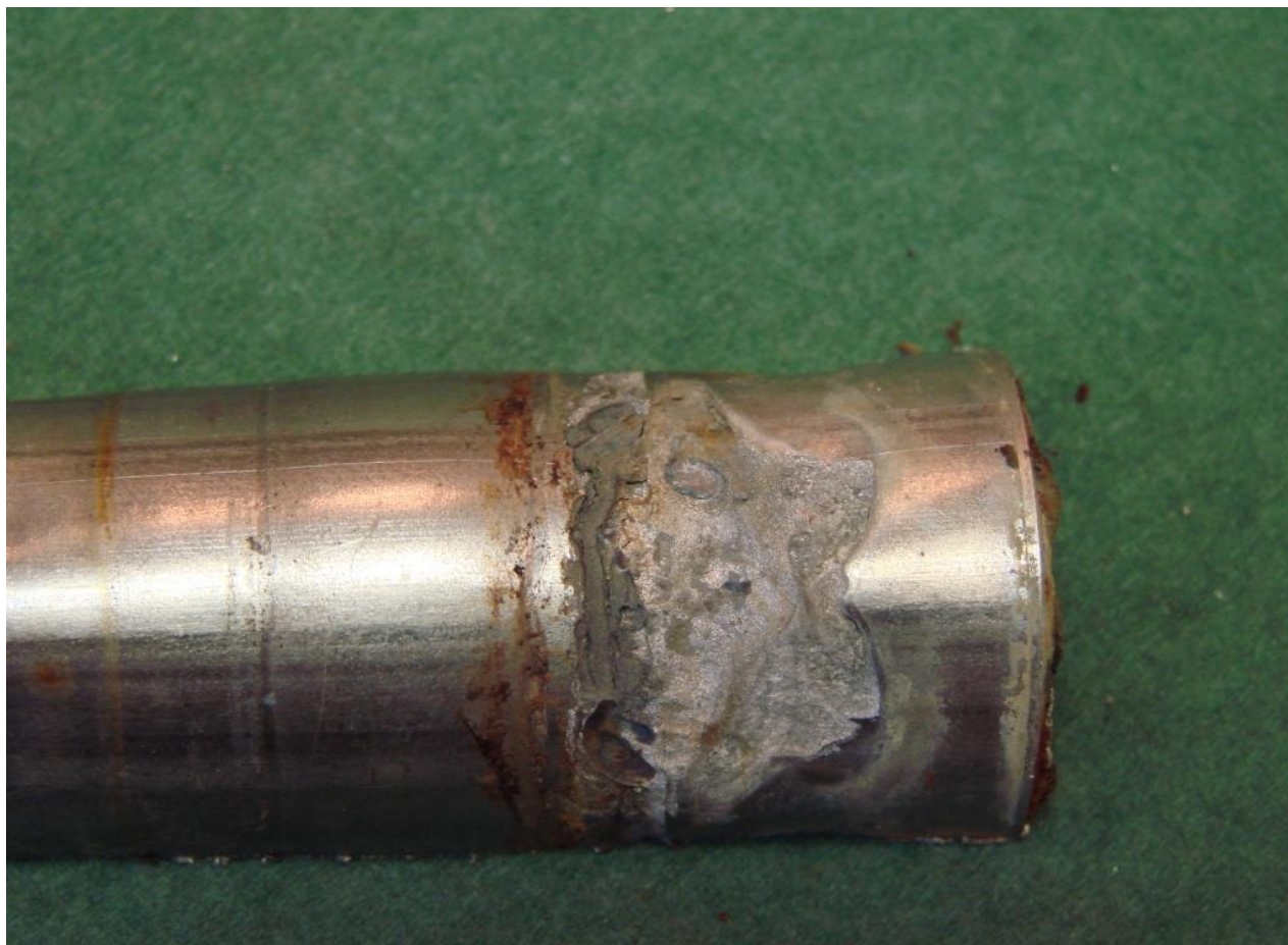
Dybt angreb på rørets yderside
