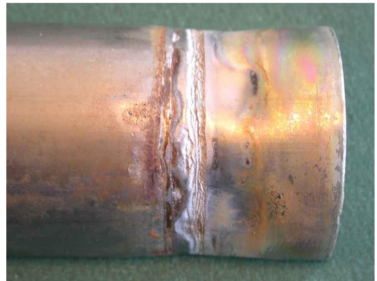
Spaltekorrosion, rør samlet med presfitting, EN 1.4404, Brugsvand
