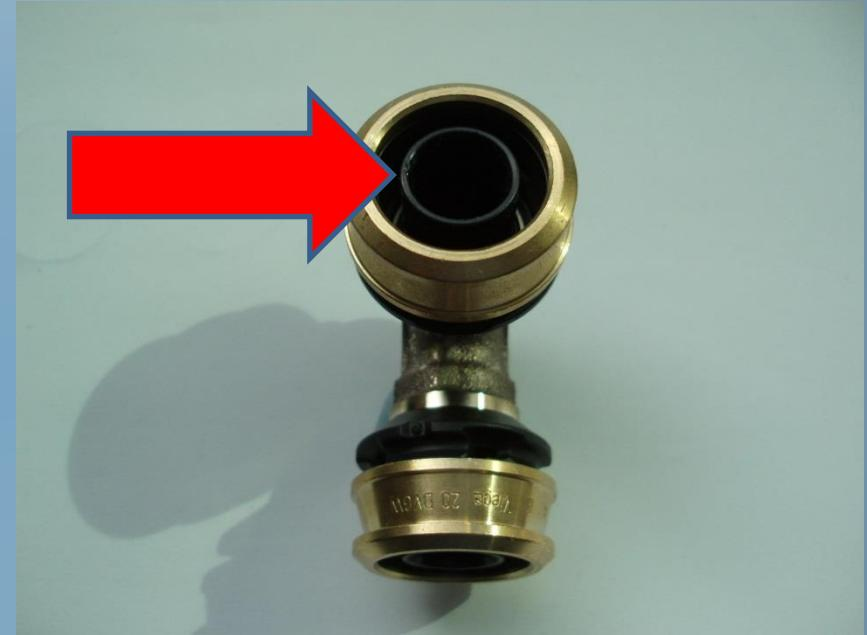
Der er stor forskel på de fastmonterede støttebøsninger der er i de forskellige typer af koblinger der findes til plastrørssystemer.
