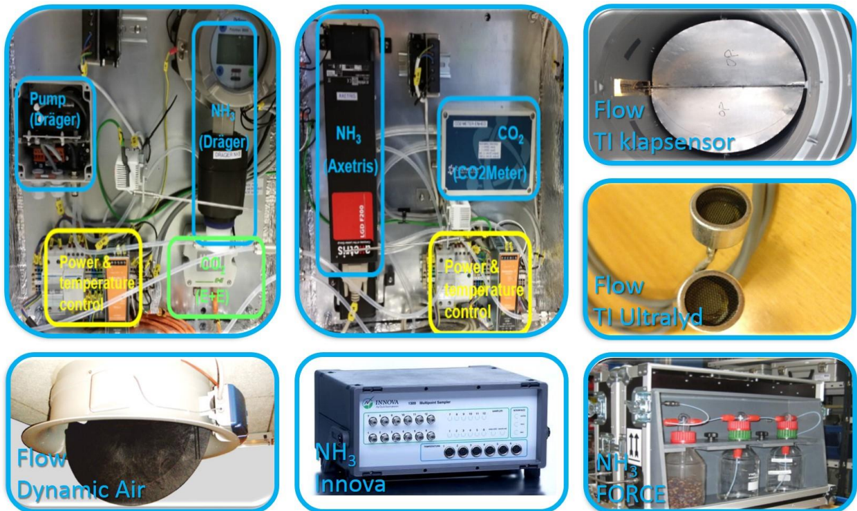
Figur 15 Billeder af de forskellige sensorer, der blev brugt under fuldskala afprøvningen på forsøgsstalden.
