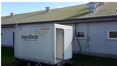
Figur 14 AgroTechs målevogn placeret midt på forsøgsstalden. Målevognen indeholder måleudstyr til centrale analyser samt lognings- og kommunikationsudstyr.
