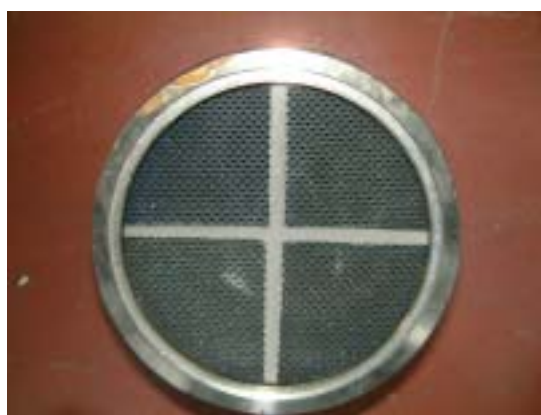
Fig 9. Udløbssiden af et brugt filter
