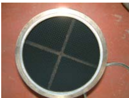
Fig 8. Indløbssiden af et brugt filter
