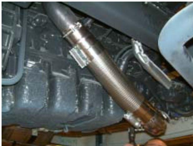
Fig. 6 – Typisk flexibel slange på udstødning
