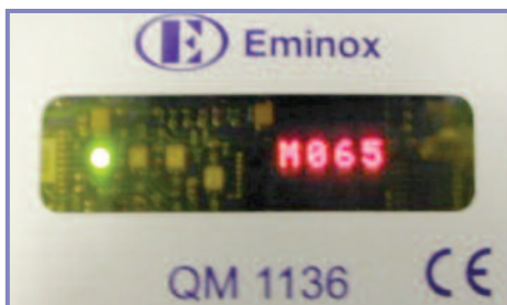
Figur 4. Display viser maksimalt modtryk
