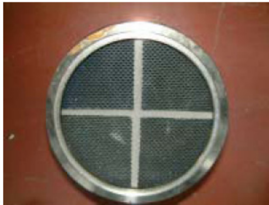
Fig 9. Udløbssiden af et brugt filter
