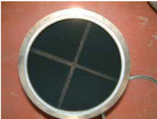
Fig 8. Indløbssiden af et brugt filter
