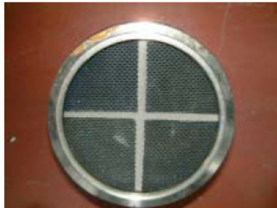
Fig 9. Udløbssiden af et brugt filter
