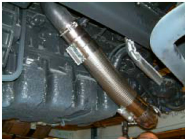
Fig. 6 – Typisk flexibel slange på udstødning
