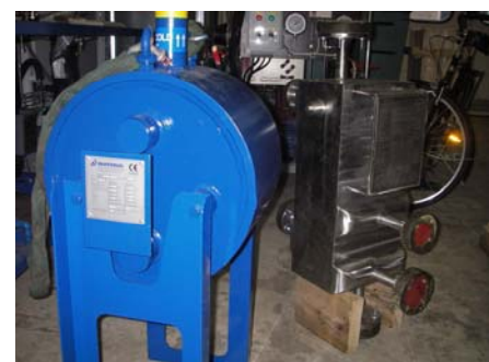
Figur 5.7: Den anvendte fordamper (venstre) og gaskøler (højre).
