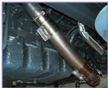
Figur 18 - Typisk flexrør, som beskytter mod vibrationer
