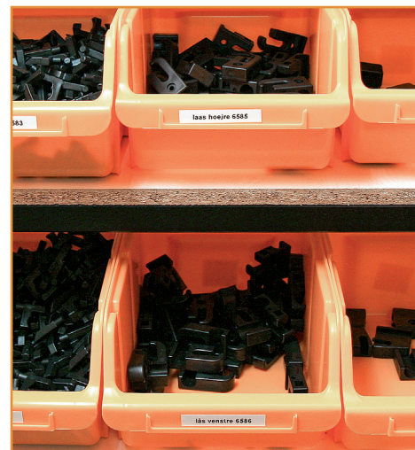
Odder Barnevognsfabrik har blandt andet skabt orden på værktøjsreolerne og indført et system med bakker til komponenter.
