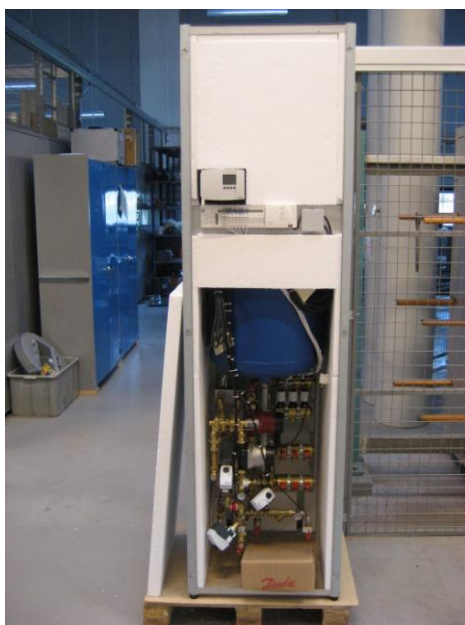
Figur 8 Prototype af fjernvarmebeholderunitten Danfoss Comfort LGM
