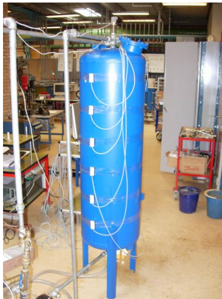
Figur 10 Test af lagdeling i beholderen
