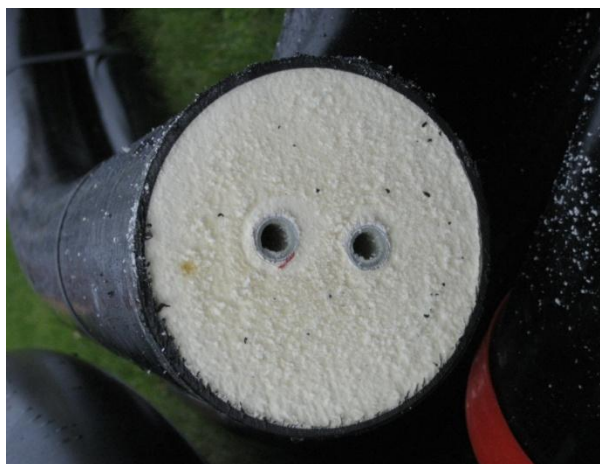
Figur 12 Tværsnit af det fremstillede prototyperør 14/14/110 mm
