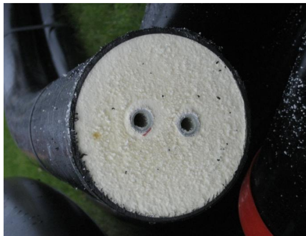
Figur 3 Tværsnit af det fremstillede prototypørør 14/14/110 mm
