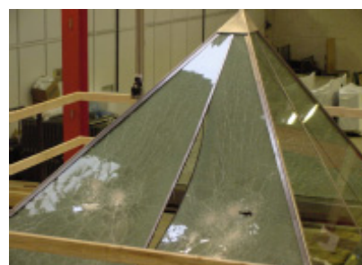
Fuldskalaforsøg med glasoverdækning
