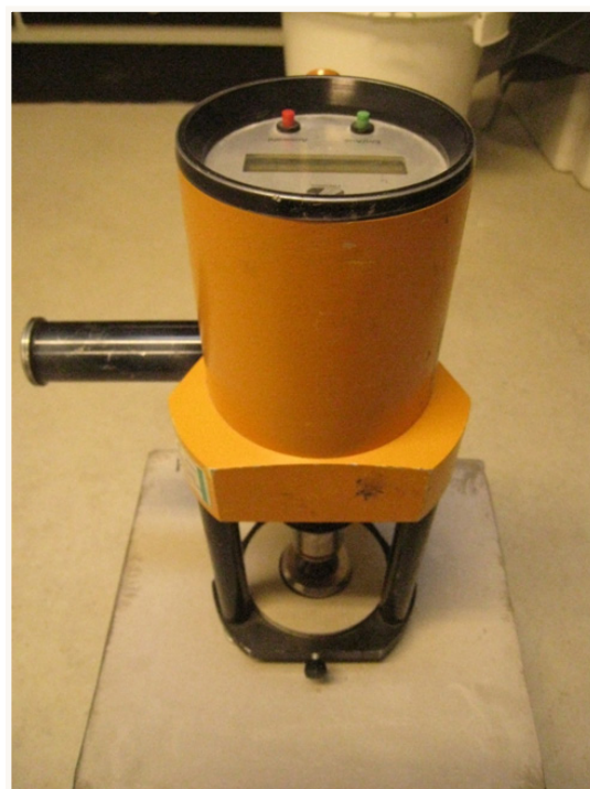
Vedhæftningsstyrke bestemmes efter udførelse af behandlingen på standardflise
