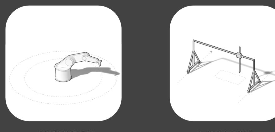
SINGLE ROBOTIC ARM PRINTER GANTRY CRANE ROBOTIC PRINTER
