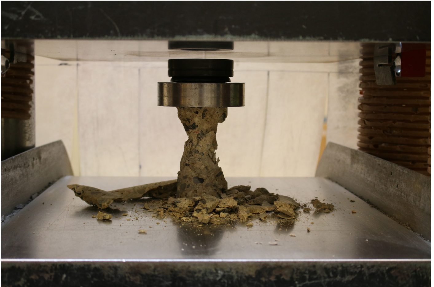
Fig. 10 Trykprøvet kerne udboret fra et genbrugte huldæk. Foto: Teknologisk Institut
