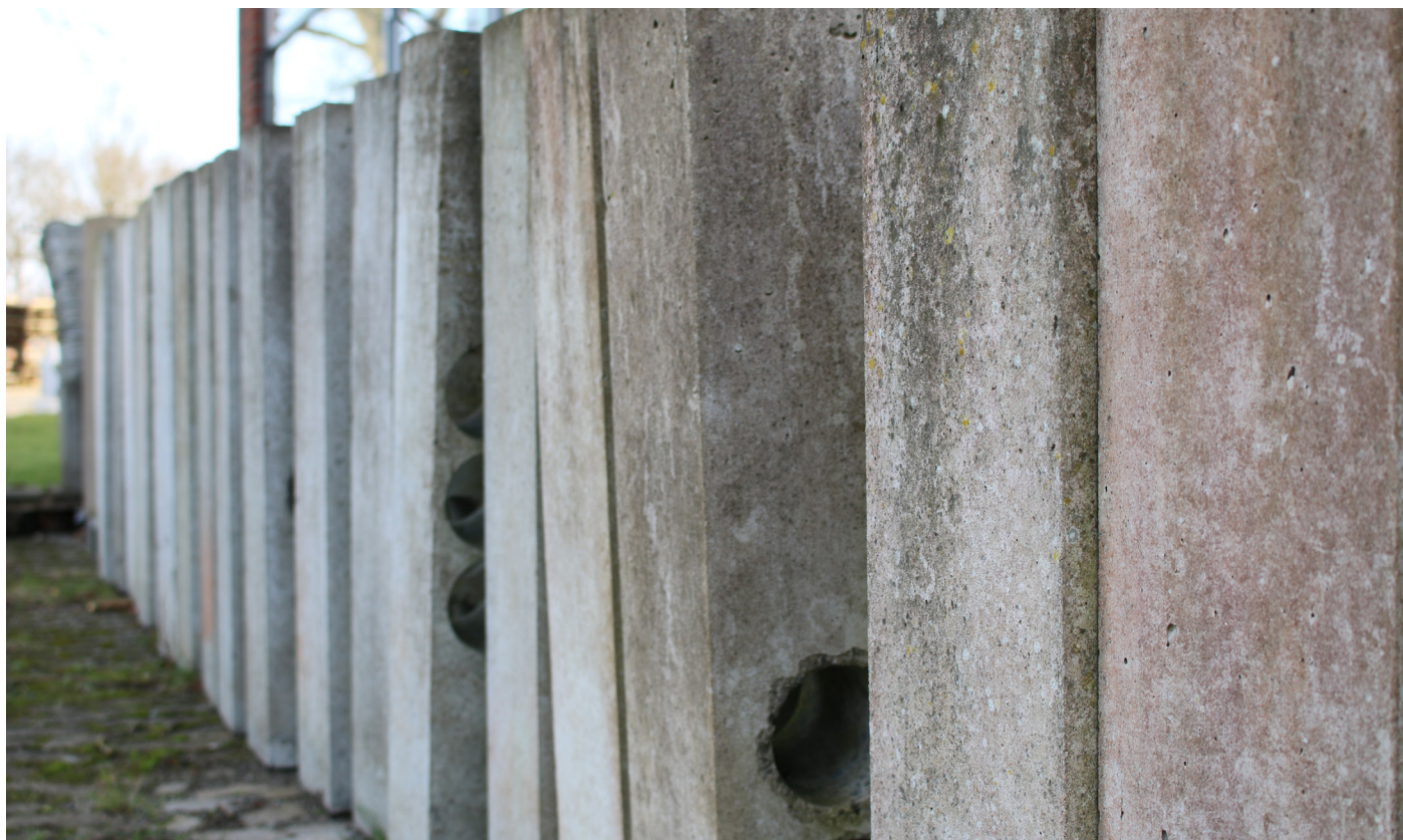
Fig. 07 Eksponeringsplads med betonblokke støbt med forskellige betonsammensætninger. Betonblokkene bruges til langtidsmonitorering af betonens holdbarhed i udendørs miljø. Foto: Teknologisk Institut
