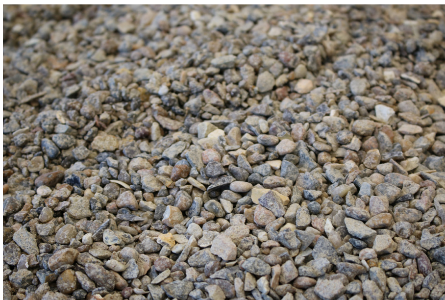
Fig. 21 Sten (også kaldet groft tilslag) anvendt i produktionen af beton. Foto: Teknologisk Institut
