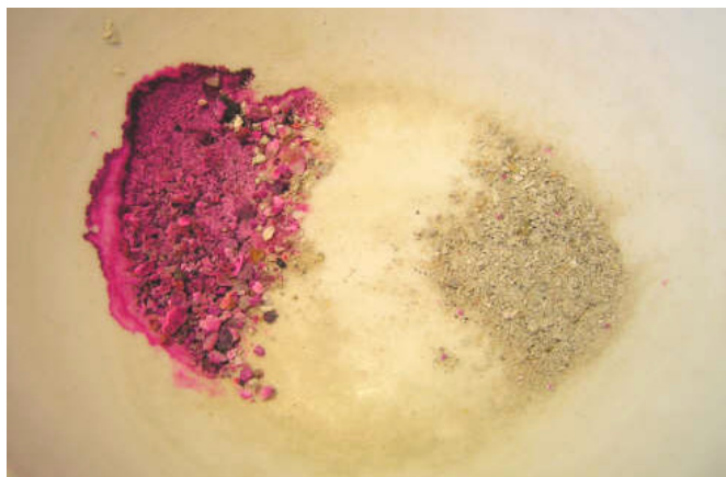
Foto 3.1 phenolphthalein behandlede prøver af karbonatiseret og ikke-karboniseret beton
