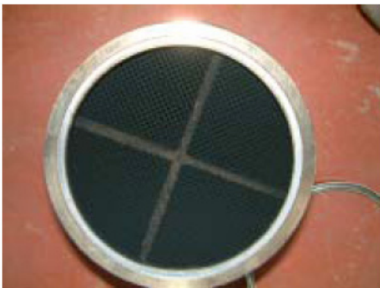
Fig 8. Indløbssiden af et brugt filter
