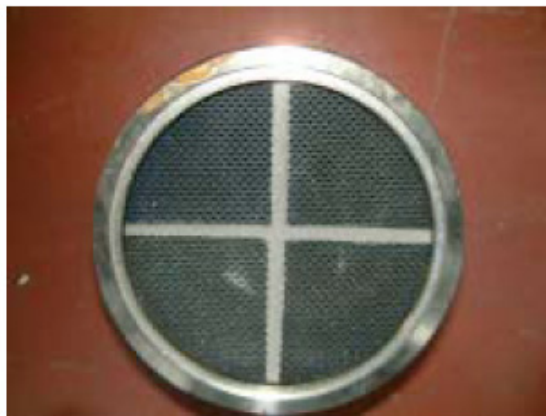
Fig 9. Udløbssiden af et brugt filter
