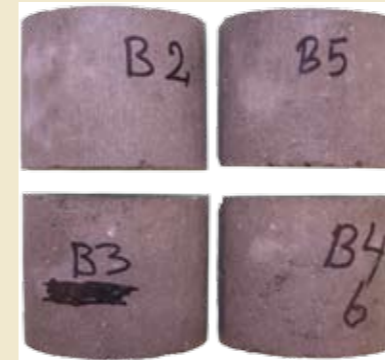
Figur 2. Overflader af prøveemner med forskellig tilslagssammensætning (B2 = Mix 1, B3 = Mix 2, B5 = Mix 3, B4 = Mix 4).
