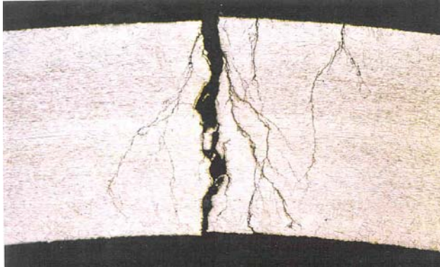
Udefra kommende spændingskorrosion på rør af AISI 304. Inddampet brugsvand (60°C).
