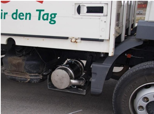
Figur 3: Indbygget partikelfilter system
