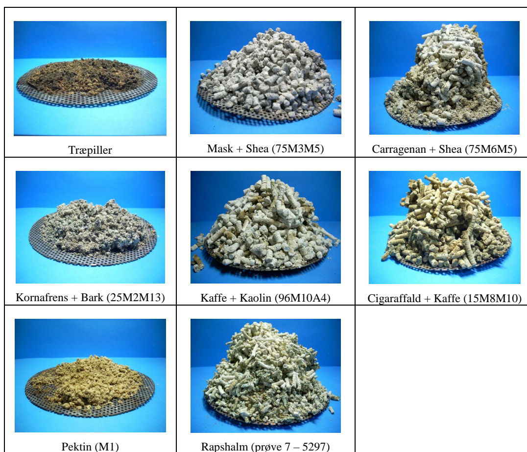
Figur 13. Aske/slagge på rist. Den omfattende aske/slagge betyder at en stor del af pillerne afbrændes /udglødes langt over risten og luftdyserne oppe i brændselmagasinet, hvilket naturligvis ikke er fremmende for forbrændingskvaliteten.
