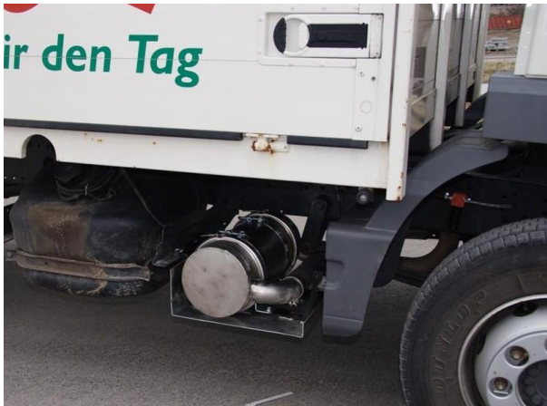
Figur 3: Indbygget partikelfilter system
