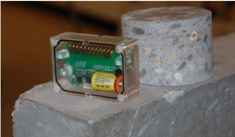
Sensor med spiralantenne for bedre senderækkevidde.
