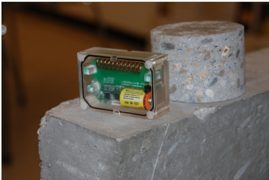
*Den seneste sensorindkapsling udført i PMMA og spiralantenne.*
