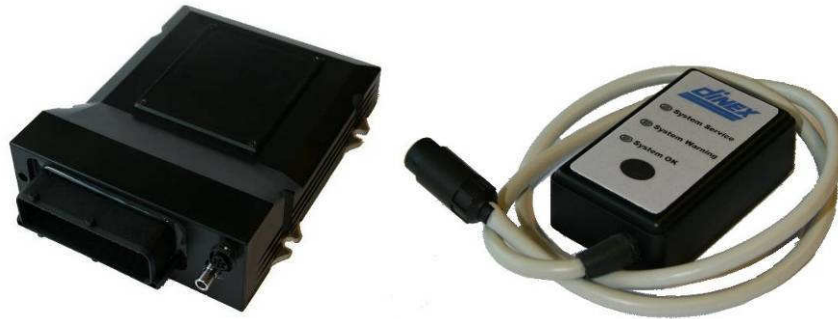
Figur 3 DiNLOG ECU og alarm display
