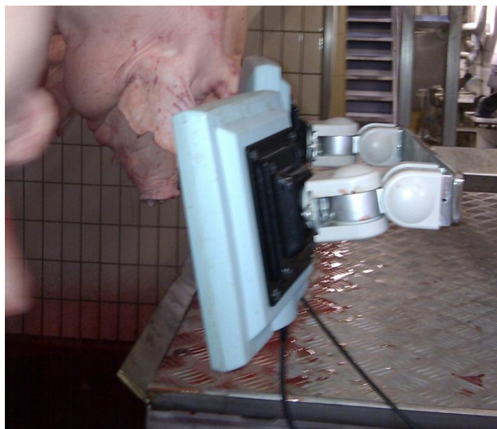
Figur 1. Antennernes placering og læseafstand.
