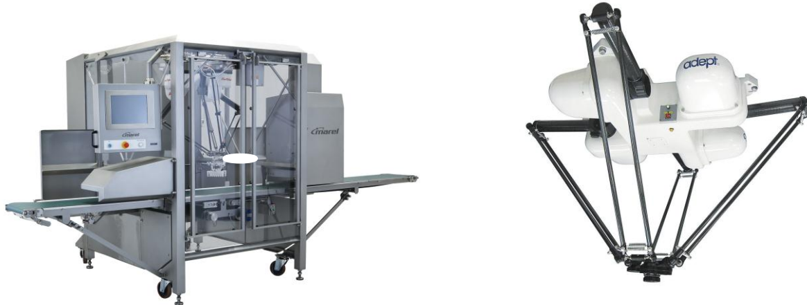
Figur 6 Hurtig pick-and-place robot (IPL), der kan samle 2-8 stykker kød i optimale kombinationer.
