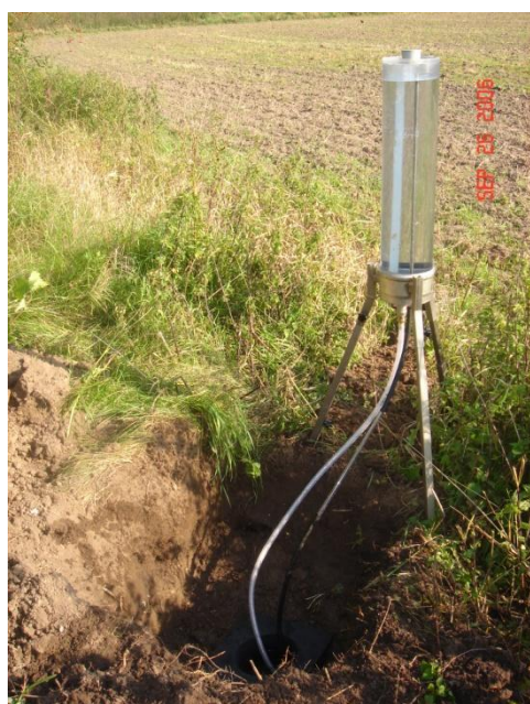
Figur 4 Infiltrometret opsat ved siden af udgravningen
