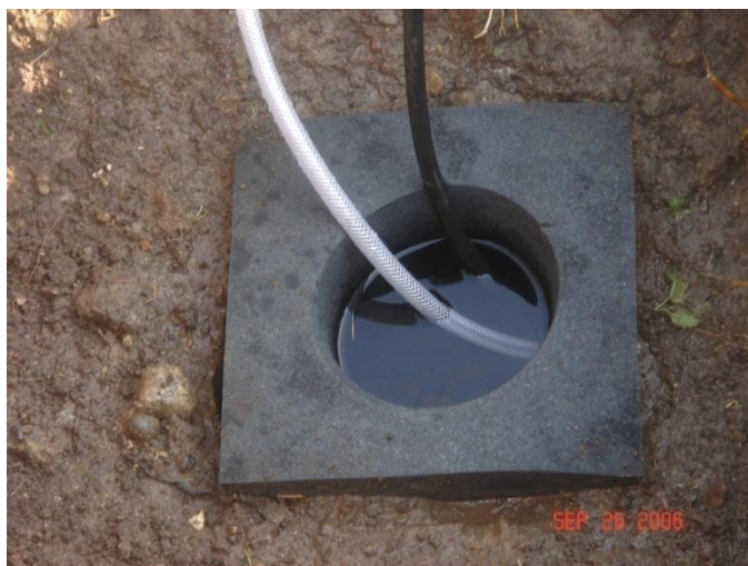
Figur 3 Udgravning der er foret med en porøs plastsvamp
