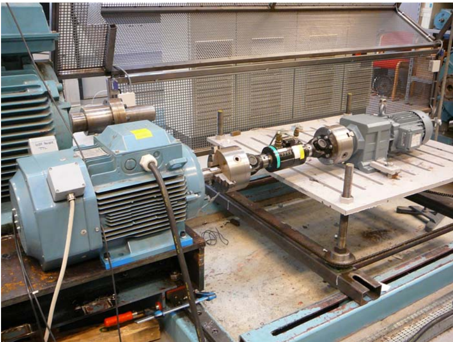
Figur 2.10. Måleopstilling på momentbænk.
